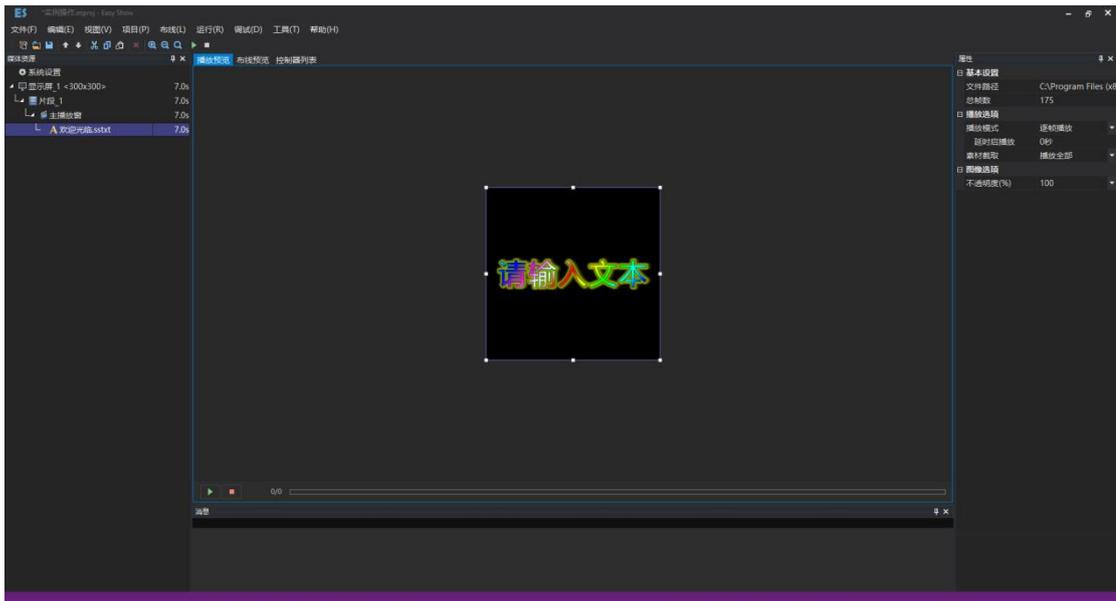
8. 点击“布线预览”，本次实例采用快速布线方式，布线文件已经根据设置自动生成，此次文件为 300×300 像素，选用 8 端口的控制器 SS-9800，软件自动生成 19 台控制器组成的布线文件，18 台使用全部端口，最后一台使用 12 个端口，即  $18 \times 18 + 12 = 300$ ，形成 300×300 的布线文件如下图所示。点击“控制器参数”设置灯具芯片信息等相关参数，保存并输出文件；
